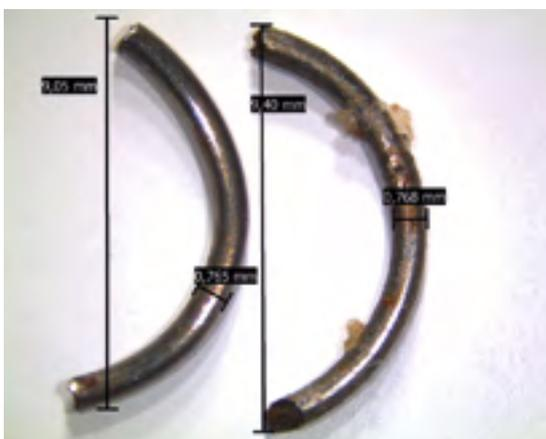
metallischer Fremdkörper in Zwiebelmettwurst
