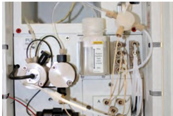
Pumpensystem des neuen Ionenchromatographen
